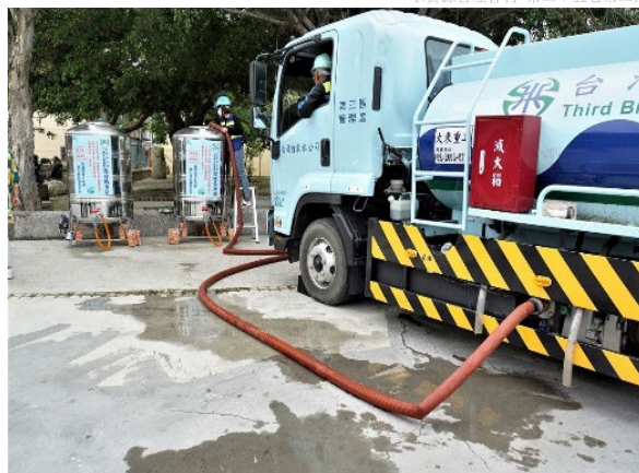
圖 8 臨時供水站儲水桶補水
