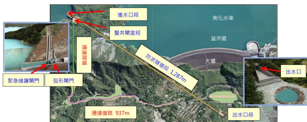
圖四 南化水庫防淤隧道平面圖
