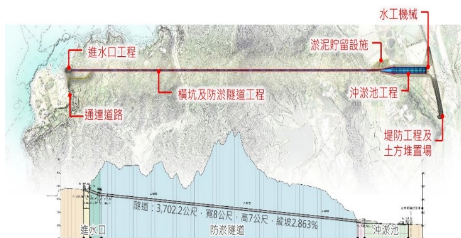
圖8 防淤隧道平面與縱斷面布置圖
