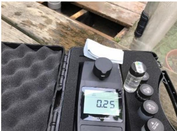
圖 5 擴水洗井以現場濁度量測管
