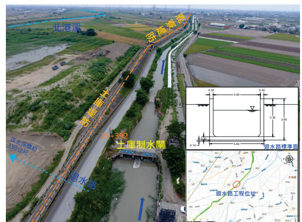
圖 23 退水路工程位置與標準斷面圖
