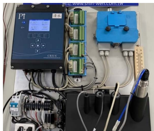
圖5 建築工地地下水5合1水質監測儀
