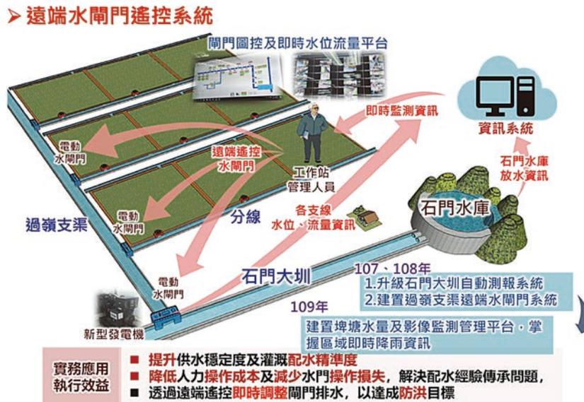
圖 9 石門管理處智慧型灌溉取供水系統示意圖
