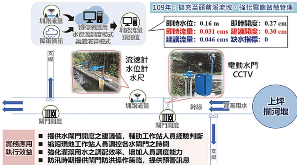
圖 11 新竹管理處智慧型灌溉取供水系統示意圖
