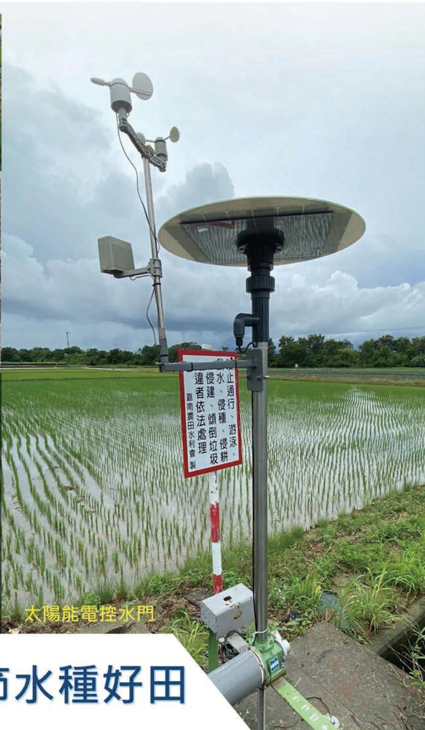
智慧灌溉技術係配合水利會現行灌溉系統，利用耐候、低耗能及低傳輸費率的電控水門、電控分水箱及流量設備、智慧灌溉決策系統及行動裝置軟體，達到適量灌溉節約用水之目的。
