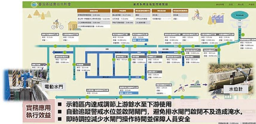
圖 13 高雄管理處智慧型灌溉取供水系統示意圖
