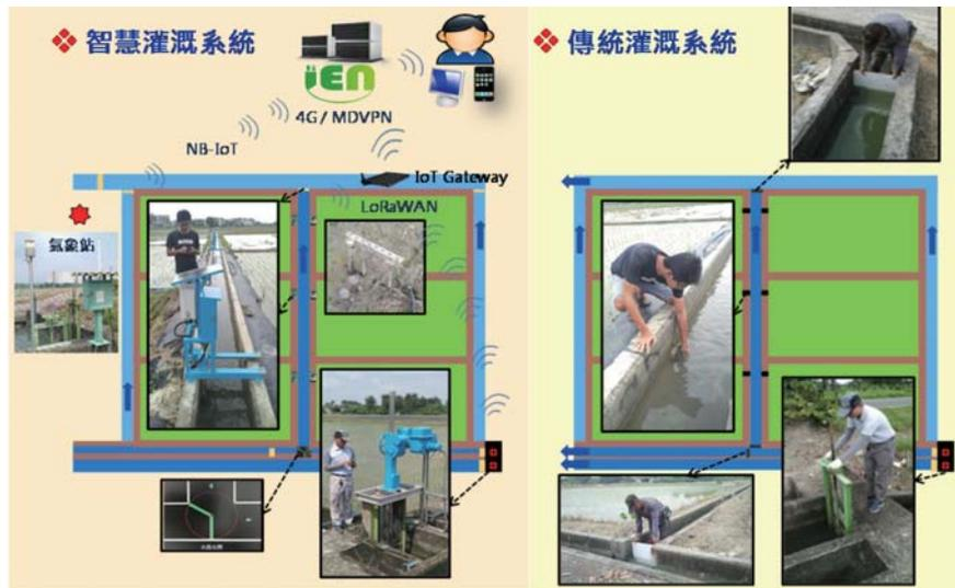
圖 2 智慧灌溉系統與傳統灌溉系統對照
