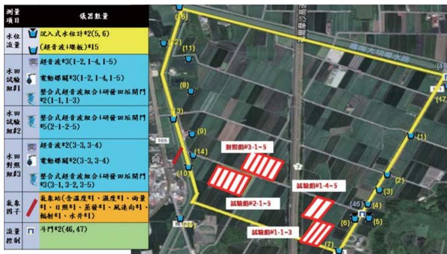
圖 3 試驗場域及監控設備佈置示意圖
