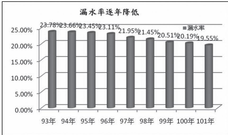
圖7 台水公司執行至101年降低漏水率計畫成效
